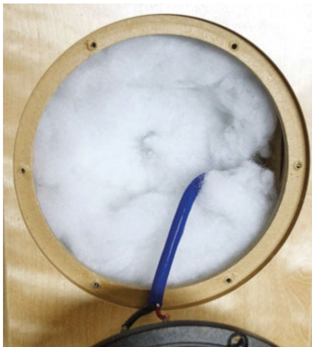
Kotelo on täytetty tiiviisti vaimennusaineella.
